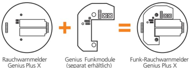
Der Rauchwarnmelder Genius Plus X wird durch Einsetzen eines Funkmoduls Basis X oder Pro X zum Funk-Rauchwarnmelder. Bewährte Genius Hx Melder können weiterhin mit den neuen Funkmodulen betrieben werden. Umgekehrt können auch neue Genius Plus X Rauchwarnmelder mit bewährten Funkmodulen Basis und Pro betrieben werden.
