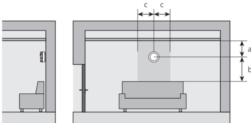
$$a = 0,3-0,5 \text{ m} \quad b \geq 1 \text{ m} \quad c \geq 0,5 \text{ m}$$
