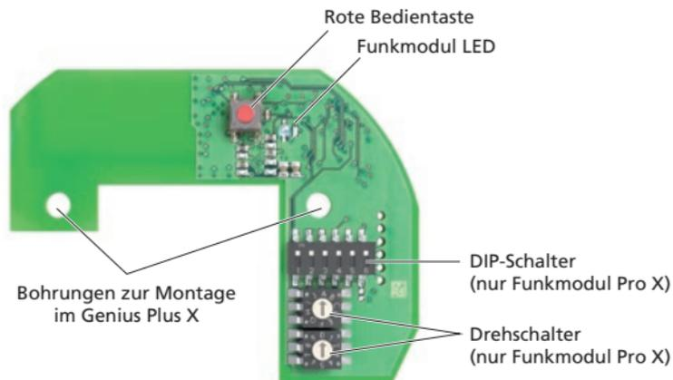
Die Funkmodule Basis X und Pro X werden in die Funkschnittstelle des Rauchwarnmelders Genius Plus X eingesetzt. Durch den Einsatz des Funk-Rauchwarnmelders Genius Plus X können Objekte flächen-deckend überwacht werden. Somit wird sichergestellt, dass ein Alarm auch aus weit entfernten Räumen nicht überhört wird.
